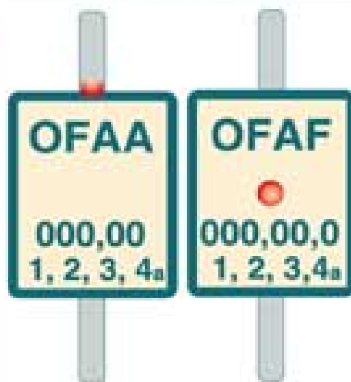
Индикатор расплавившейся вставки FuseLine
