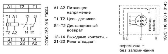
**Схема соединений CM-MSS, 1-канальный, 2 п.к.**
