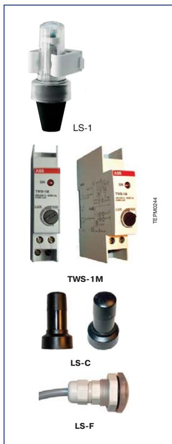
Реле используется для включения и/или выключения освещения в соответствии с установленным уровнем освещенности окружающей среды. Оно работает вместе с фотоэлементом, который формирует сигнал, соответствующий уровню освещенности. Прибор может выпускаться в исполнении со встроенным реле времени, что позволяет включать и отключать нагрузку через заданное время в зависимости от уровня освещенности. В комплект всех приборов TWS входит датчик освещенности для настенного монтажа (LS-1).
