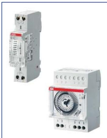
Эти реле используются для размыкания и замыкания цепи согласно заданной программе. Реле имеют функцию постоянного включения или отключения. Имеются исполнения с суточным и недельным циклом программирования. Приборы ATS-1R и ATS-7R снабжены встроенным аккумулятором, который заряжается от электросети и обеспечивает сохранность программы при длительном (до 150 ч) отключении электропитания.
