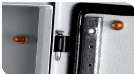
Заземляющие соединения предусмотрены внутри корпуса, на дверце и на монтажной панели. Омедненные болты заземления имеют шайбу для контакта и не требуют удалять краску и наносить пасту для контакта.
