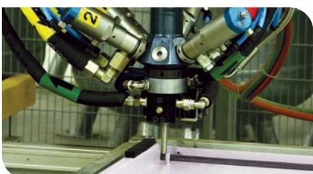
Надежное уплотнение достигается благодаря литой прокладке из полиуретана, наносимой роботом методом непрерывной отливки. Литая уплотнительная прокладка может быть перекрашена устойчива к температурам от -40 до 120 °C.
