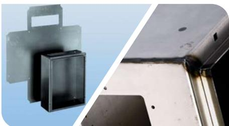
Корпус выполнен из одного листа стали. Стыки корпуса сварены непрерывным циклом для придания жесткости и плотности. Желоб по краю корпуса обеспечивает дополнительную жесткость корпуса и препятствует попаданию грязи и воды внутрь при открытии шкафа.
