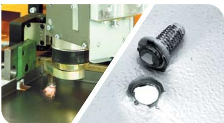
Применение уникальной технологии приварки болтовых мезизов, позволяет максимально нагружать монтажную панель оборудованием.
