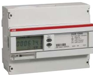
Счетчики DELTAplus производства компании АББ предназначены для учета активной и активно-реактивной электрической энергии в однофазных и трехфазных сетях переменного тока, как по одному, так и по нескольким тарифам (до двух тарифов с использованием реле времени DTS7/1 и до четырех тарифов с использованием реле времени DTS7/2).
