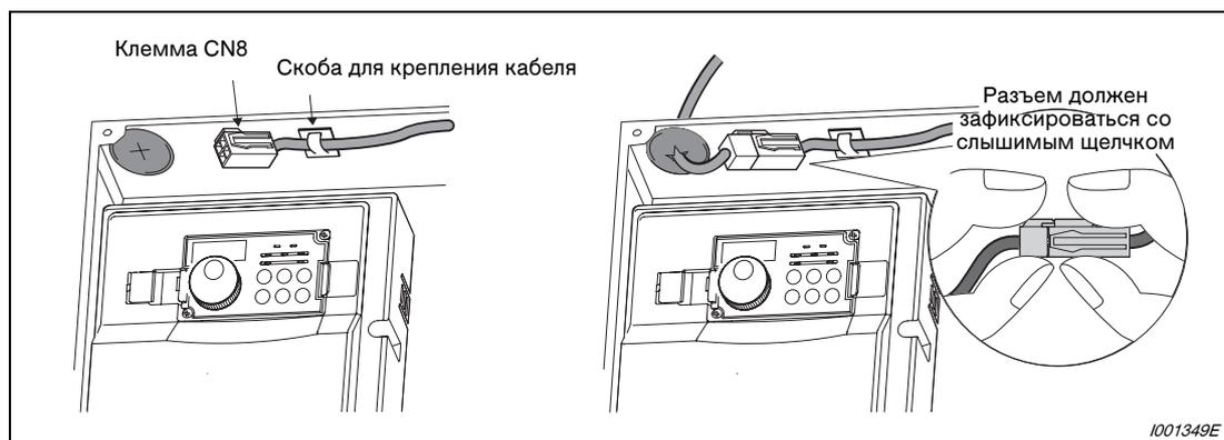
Рис. 3-38: Подключение клеммы CN8
