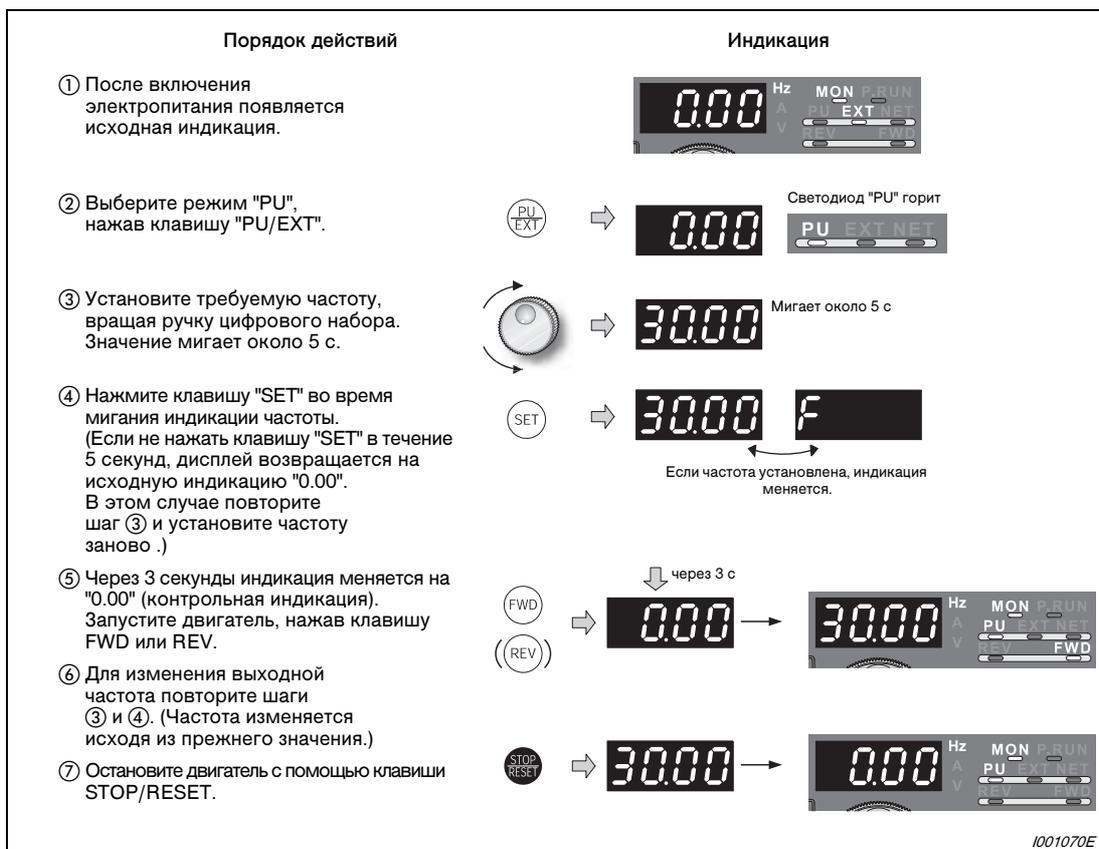
Рис. 5-17: Настройка частоты с помощью ручки цифрового набора
