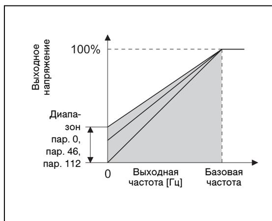
*Рис. 5-3: Взаимосвязь выходной частоты и выходного напряжения*
